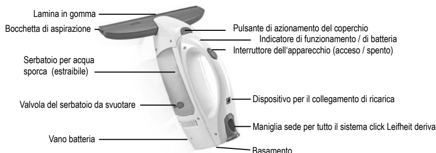
Figura 2: Dispositivi di comando del puliscivetri
