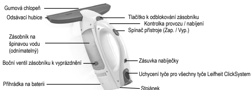
Obrázek 2: Obslužné prvky okenní odsávačky
