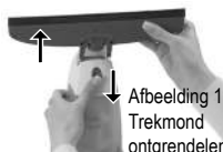
Afbeelding 13: Bevestigen van de tank
