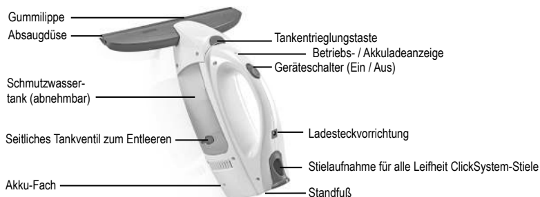
Abbildung 2: Fenstersauger Bedienelemente
