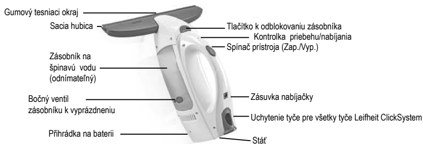
Obrázok 2: Obslužné prvky okenej odsávačky
