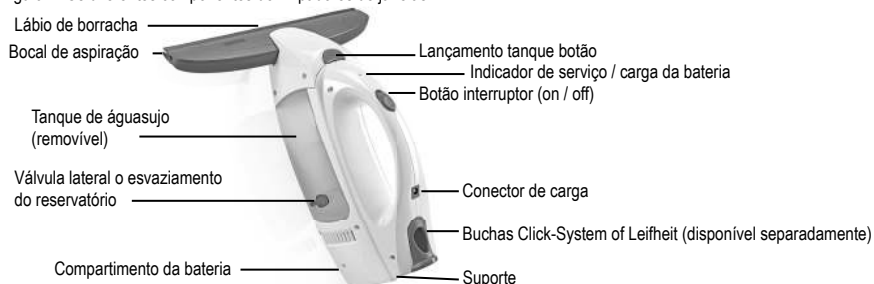
Figura 2: Os diferentes componentes do limpadores de janelas
