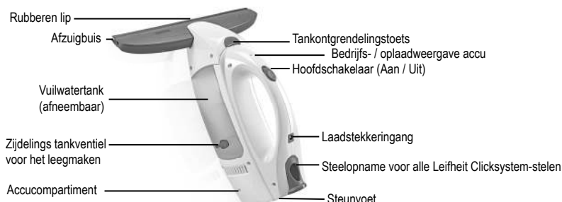
Afbeelding 2: Vensterzuiger bedieningselementen
