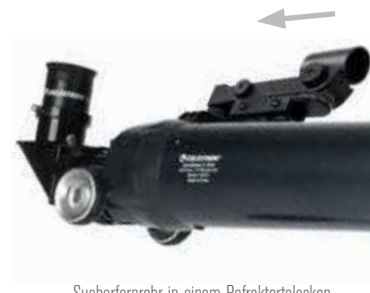
Sucherfernrohr in einem Refraktorteleskop
