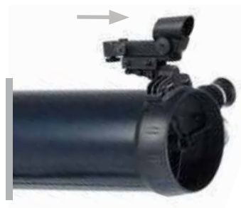
Sucherfernrohr in einem Newton-Teleskop
