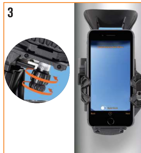
3. Zentrieren Sie dann Ihr Smartphone über dem Spiegel des StarSense-Docks. Drehen Sie die Knöpfe an der Unterseite der Halterung, bis die Kameraansicht Ihres Smartphones ungehindert im Spiegel zentriert ist.
