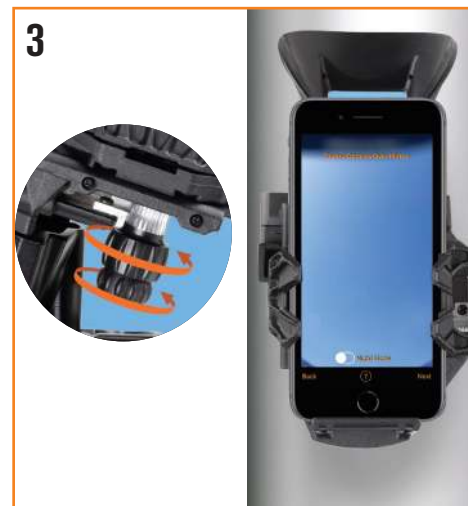
3. Successivamente, centrare il telefono sullo specchio del dock StarSense. Ruotare le manopole nella parte inferiore della staffa fino a quando la vista della fotocamera del proprio telefono è centrata, non ostruita, nello specchio.
