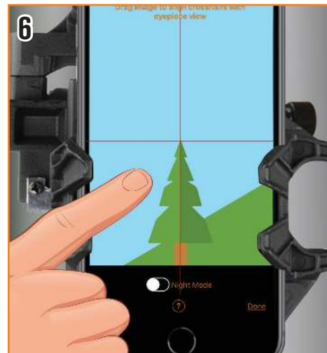
6. Verschieben Sie die Kameraansicht, bis das gleiche Objekt im Fadenkreuz zentriert ist.
