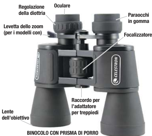
BINOCOLO CON PRISMA DI PORRO
