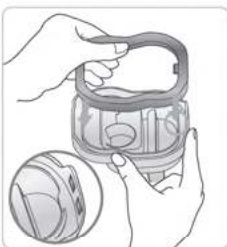
1. 如图所示，将橡胶密封圈安装到槽内。
