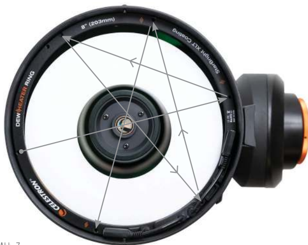
Abb. 7 Ziehen Sie die Schrauben, wie dargestellt, abwechselnd über Kreuz an.
