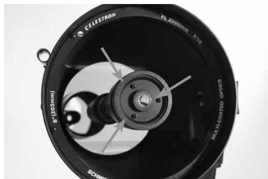
Einstellschrauben für die sekundäre Spiegelkollimation
