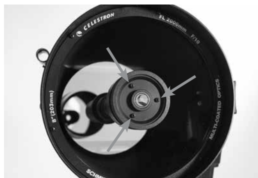
Vis d'ajustement de collimation du miroir secondaire
