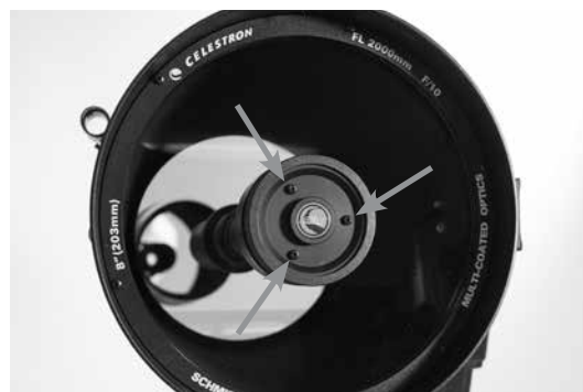
Collimazione dello specchio secondario regolando le viti
