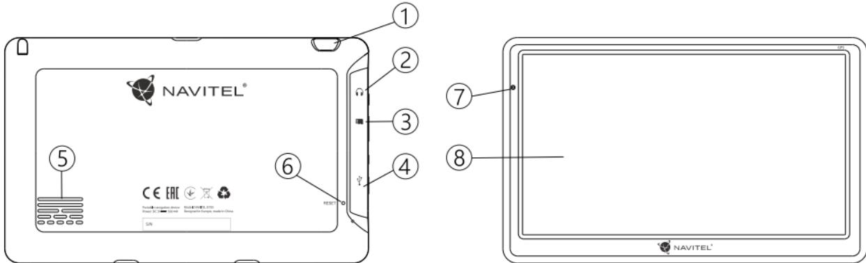
1. Кнопка включения/выключения навигатора.
