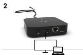
1 monitor připojený přes DisplayPort/HDMI kabel – rozlišení až 4K 3840x2160/60Hz.
