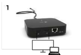
1 monitor připojený přes 2 DisplayPort kabely – rozlišení až 5K 5120x2880/60Hz.
