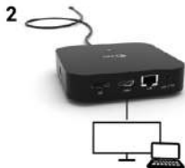
1 monitor připojený přes DisplayPort/HDMI kabel – rozlišení až 4K 3840x2160/60Hz.
