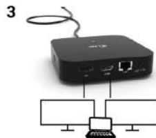
2 monitory připojeny přes DisplayPort/HDMI kabely – rozlišení až 4K 3840x2160/60Hz.
