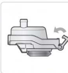
3. 锁上蒸汽帽锁扣。 * 分离方法和组装方法顺序相反。
