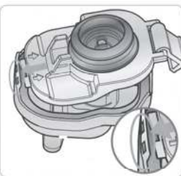
2. 将蒸汽帽对准孔后安装。
